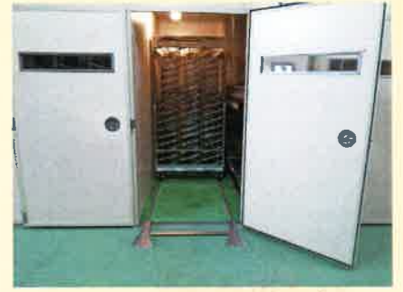
出入口扉の床面にアングルを取り付けている為、確実な機内密閉が可能です。
